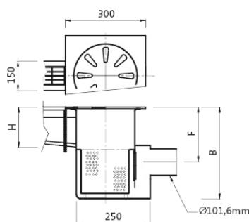
**PC.003GL** Sifon cu doua conexiuni, cu descarcare orizontala
