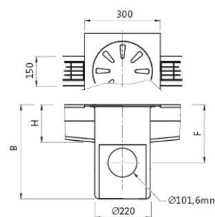
**PC.002GL** Sifon cu o singura conexiune, cu descarcare orizontala
