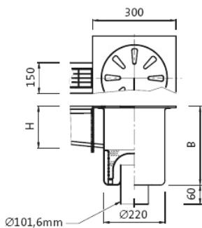
**PC.002GV** Sifon cu o singura conexiune, cu descarcare verticală
