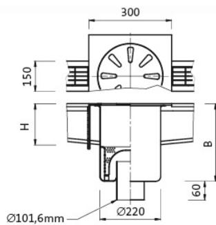
**PC.003GV** Sifon cu două conexiuni, cu descarcare verticală
